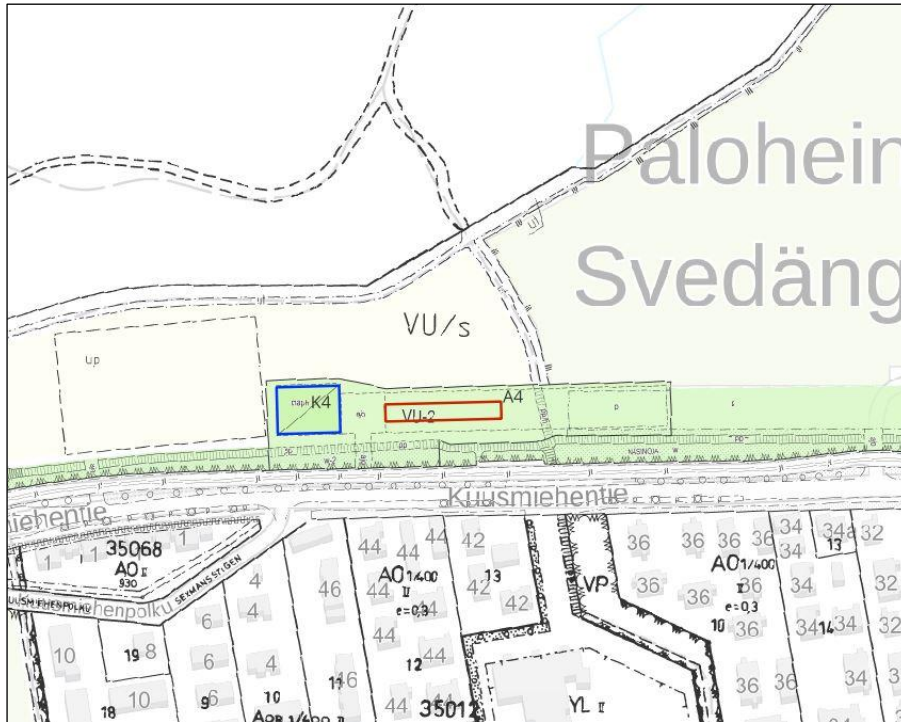
Kuva 2.15 Ote ajantasa-asemakaavasta., jonka päällä on osoitettu kuilun K4 (sinisellä) ja ajotunnelin A4 (punaisella) merkinnät. Ajantasa-asemakaavasta puuttuu ma-ajo-merkintä, joka on virallisessa asemakaavakartassa.
