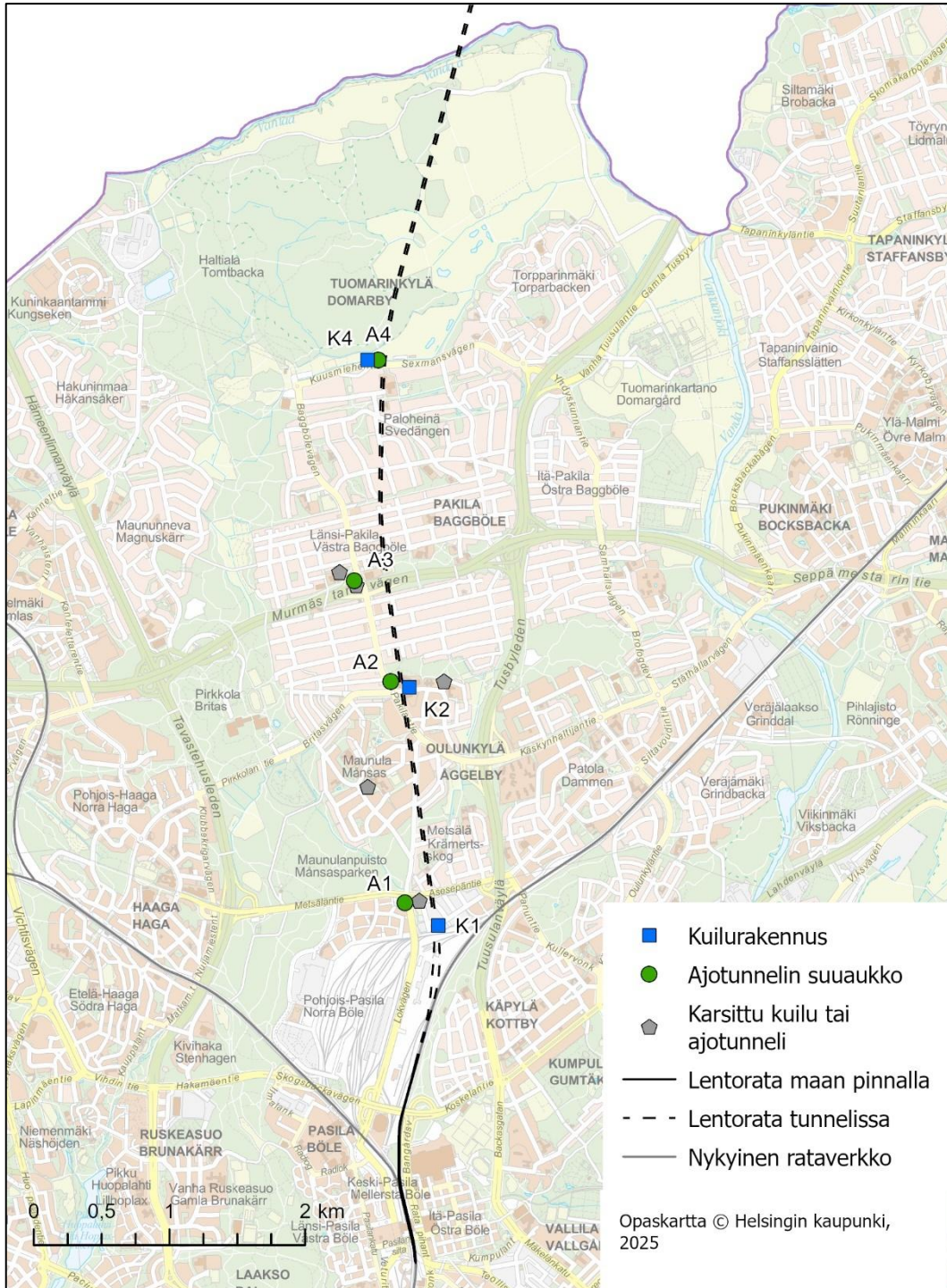
Kuva 3.7 Kuilujen ja ajotunneleiden vaihtoehtotarkastelut Helsingissä
