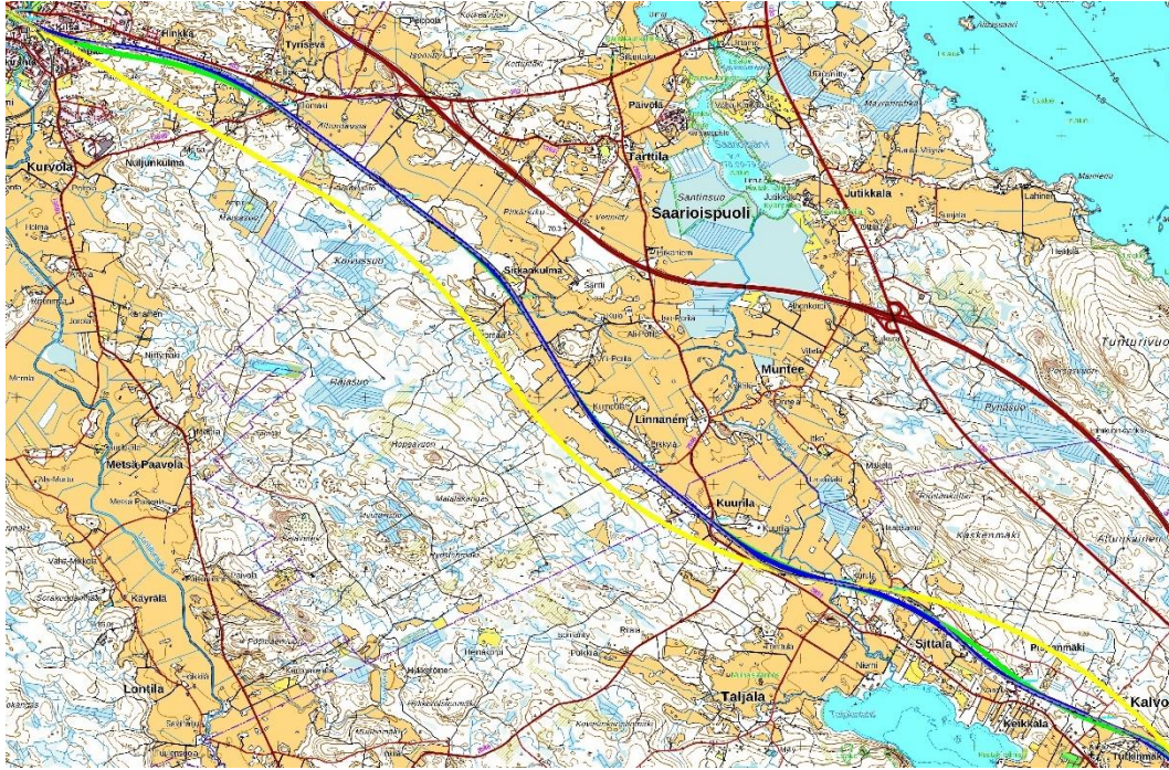
Kuva 2.8 littalan ja Toijalan väliin tarkastellut rataoikaisut kolmella eri nopeudella
